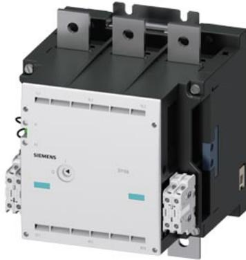
contactor, Tamaño 14, 3 polos, AC-3, 450kW, 400/380V (690V) Bloque de contactos auxiliares 44 (4NA+4NC) mando por AC AC 380...460V 50/60Hz
