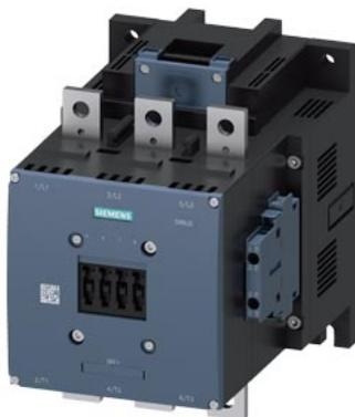
Contactor de potencia, AC-3 400 A, 200 kW/400 V AC (50-60 Hz)/mando por DC 220-240 V UC Bloque de contactos auxiliares 2 NA + 2 NC 3 polos, tamaño S12 conexiones de barras accionamiento: convencional conexión por tornillo
