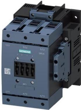
Contactor de potencia, AC-3 115 A, 55 kW/400 V AC (50-60 Hz)/mando por DC 440-480 V UC Bloque de contactos auxiliares 2 NA + 2 NC 3 polos, tamaño S6 con bornes tipo marco accionamiento: convencional conexión por tornillo
