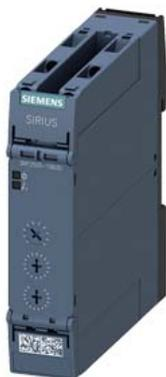
relé temporizador, multifunción 2 conmutados, 27 funciones 7 rangos de tiempo (0,05 s...100 h) AC/DC 24 V con AC 50/60 Hz con LED, borne de tornillo
