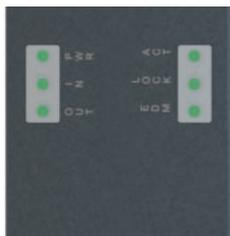
Están diseñados para un diagnóstico rápido e inmediato y el estado de cada entrada y salida se señaliza mediante un LED. Esto le permite identificar rápidamente los puntos de interrupción de la cadena de seguridad, qué dispositivo está desbloqueado y qué puerta está abierta, y cualquier fallo en el dispositivo. Todo inmediatamente, sin necesidad de descodificar secuencias complejas de parpadeos.
